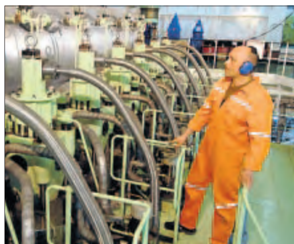
Der zweite Ingenieur Wladimir Iwanow steht an der Schiffsmaschine. Sie leistet knapp 30 000 PS und wird mit Schweröl betrieben, das auf 130 Grad aufgeheizt wird, bevor es verbrannt werden kann. Dazu wird über ein Wärmetauscher die Hitze der Abgase genutzt.
